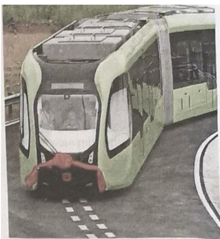
**Es fährt bereits.** Der Hersteller CRRC lässt ein fahrleitungsfreies Pneu-Tram auf Asphalt fahren.
